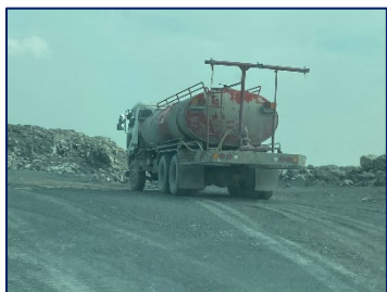
1. ฉีดพรมน้ำบริเวณที่ก่อให้เกิดฝุ่นละออง
